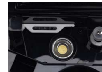
Wassereinhaltung durch Ionic Silver Stick (optionales Zubehör) korrosionsbeständige Membranoberfläche aus Titan
